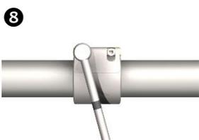
Поместите муфту на стык и закрутите болты НЕ ДО КОНЦА, постоянно чередуя болты во время затяжки. Максимальная скорость закрутки болтов – 120 об/мин.
